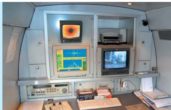
Wnętrze specjalistycznego samochodu do teleinspekcji kanałów – Białskie Wodociągi (fot. M. Kucharczyk)
