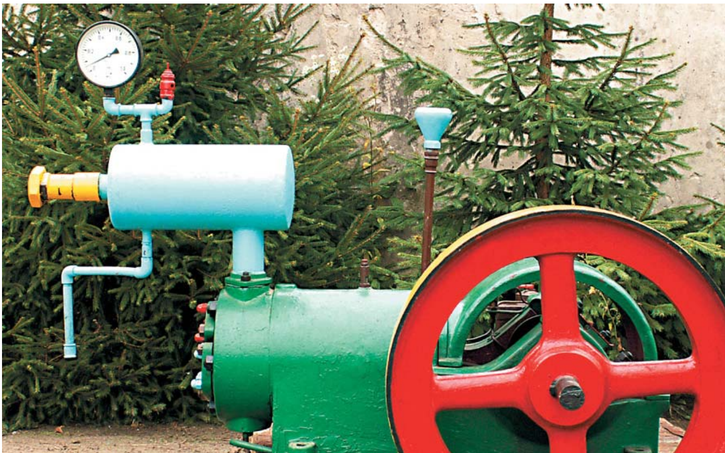
Elbląg, woj. warmińsko-mazurskie. Unikalna pompa mamutowa: sprężone powietrze dostarczane przez dmuchawę do zanurzonego w ściekach mieszacza tworzyło z osadu emulsję, która jako lżejsza od ścieków była wypychana ku górze przewodu tłocznego (foto M.J. Kownacki, opis A. Przybylski EPWiK Elbląg)
