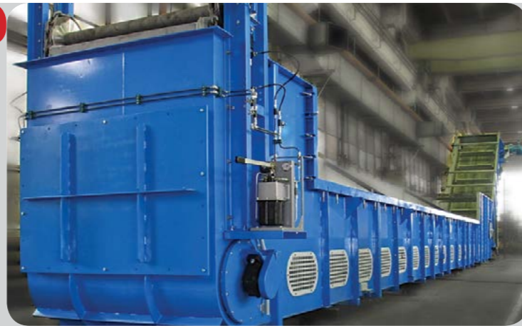
Przenośnik popiołu (21m długość, 5m wys.) / Ash conveyor (l. 21m, h. 5m)
