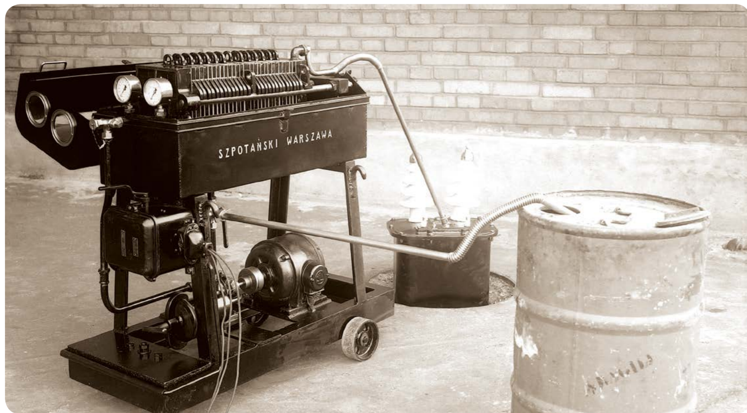
Urządzenie do filtrowania oleju transformatorowego / Transformer oil filter unit (arch. Photofactory®)
