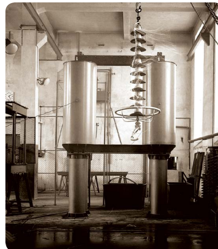
Zaplecze badawczo-rozwojowe w fabryce Szpotańskiego. Próba napięciowa łańcucha izolatorów z armaturą ochronną wykonywana za pomocą transformatora probierczego 600 kV i mocy trwałej 165 kVA (po lewej). Transformator probierczy na napięcie 1 600 000 V wykonany w Fabryce Aparatów Elektrycznych (po prawej) / R&D facilities at the Szpotański Factory. Voltage test of the chain of insulators with protective fittings by means of a 600 kV test transformer with continuous rating 165 kVA (on the left); 1600 000 V test transformer produced by the Electrical Engines Factory (on the right) (arch. Photofactory®)
