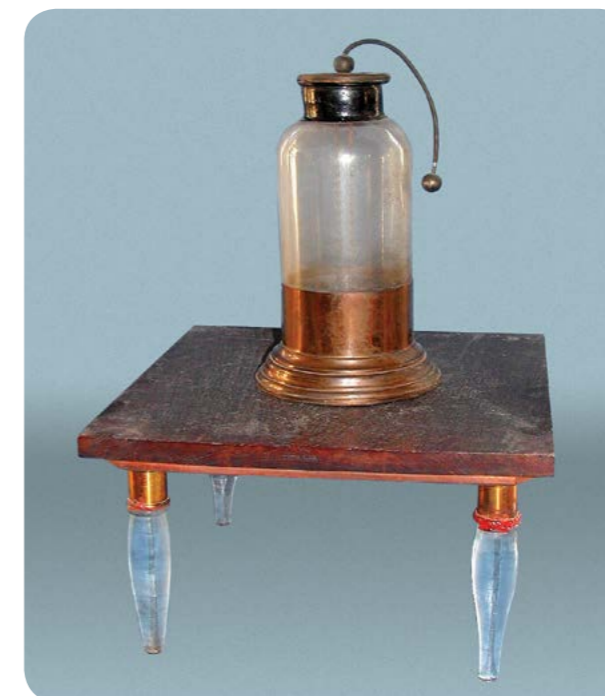
Butelka lejdejska – pierwszy kondensator / The Leyden jar – the first capacitor (arch. Photofactory®)
