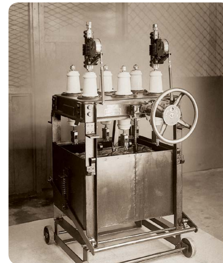
Wyłącznik olejowy R10 z przekąźnikami BBC / R10 oil switch with BBC transmitters (arch. Photofactory®)
