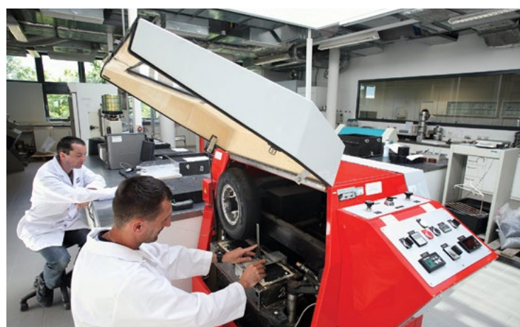
Aparat do badania koleinowania w laboratorium TPA, STRABAG
