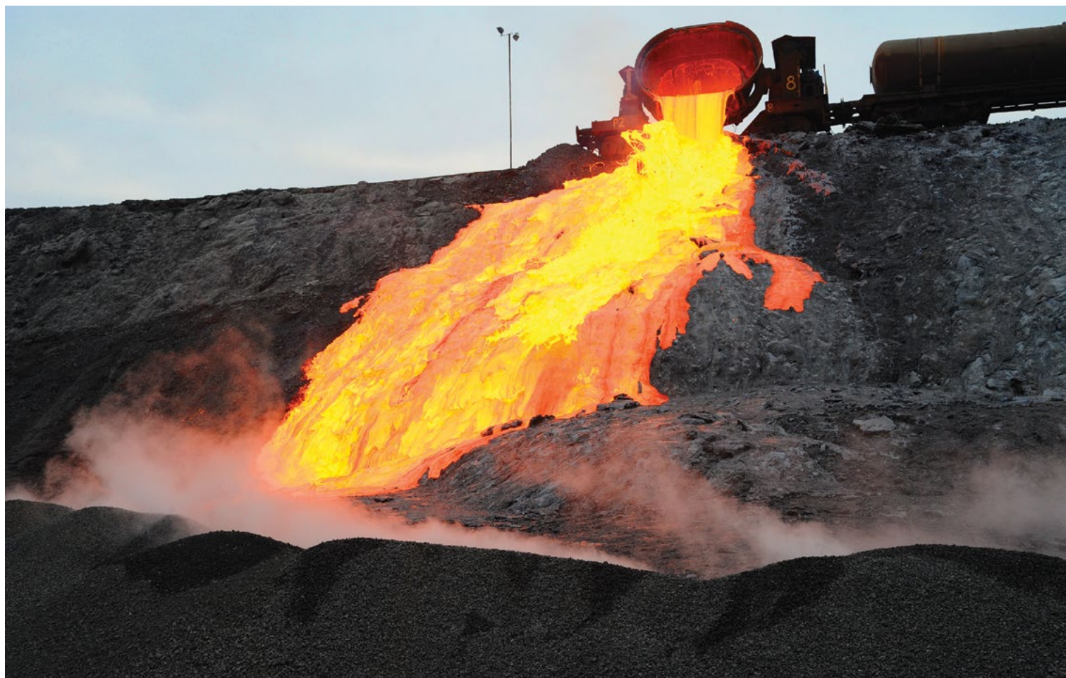
Wylanie płynnego żużla szybowego, KGHM METRACO
