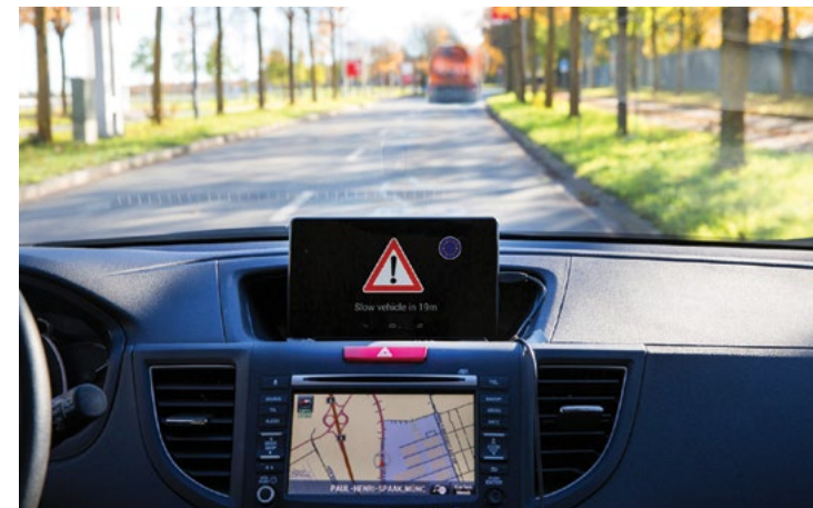
Technologia V2V (Vehicle-to-Vehicle) zapewnia dynamiczną, bezprzewodową wymianę danych między pojazdami znajdującymi się w niewielkiej odległości
