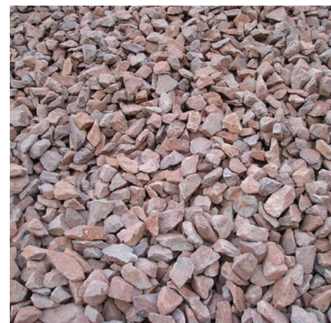
W zależności od rozmiaru ziaren kruszywa dzieli się na grube, drobne, o ciągłym uziarnieniu i wypełniacze
