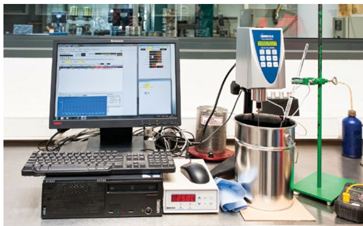
Laboratorium TPA. Oznaczenie lepkości asfaltu modyfikowanego gumą za pomocą lepkościomierza, STRABAG
