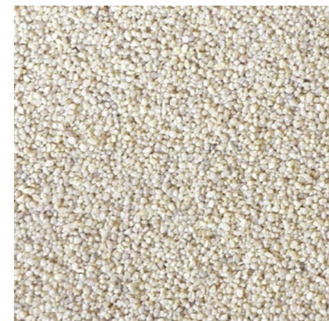
W zależności od rozmiaru ziaren kruszywa dzieli się na grube, drobne, o ciągłym uziarnieniu i wypełniacze
